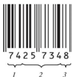
Рис 8. Расшифровка штрих-кода EAN-8:
