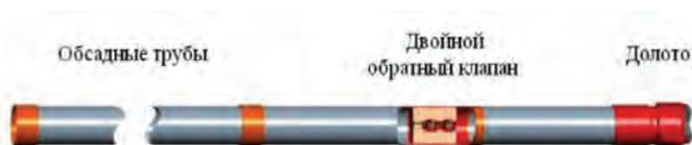
Рисунок 1 – Неизвлекаемая компоновка для бурения на обсадной колонн
