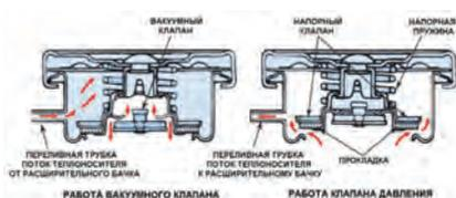
Рисунок: Подпружиненный напорный клапан.
