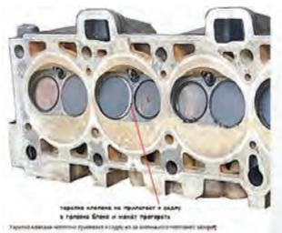
Рис. Неплотное прилегание клапанов
