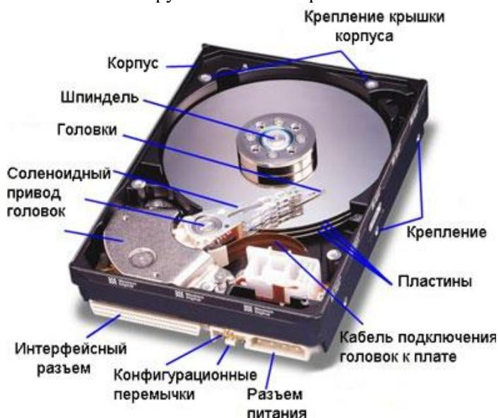
Накопитель на жестких магнитных дисках, жесткий диск или винчестер, (англ. Hard Disk Drive, англ. HDD) — энергонезависимое, перезаписываемое компьютерное запоминающее устройство. Является основным накопителем данных практически во всех современных компьютерах.
