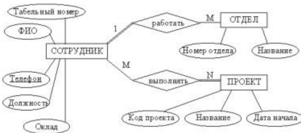
Рисунок 1. Пример ER–диаграммы с однозначными и многозначными атрибутами Пример проектирования реляционной базы данных
