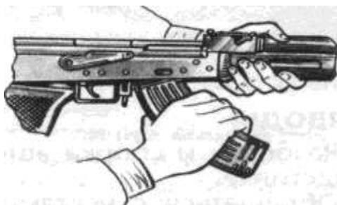
6) **Спустить курок с боевого взвода и поставить на предохранитель.** Нажать на спусковой крючок и поднять переводчик огня вверх до отказа.
